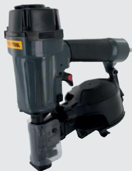
Автоматический пневматический заклёпочник для фиксации гвоздями с широкой шляпкой, подходит для битумных мембран или канадской черепицы. Для гвоздей от 3x19 до 3x45. Вес - 2,3 кг.
