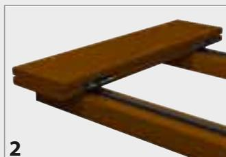
2. Вставьте в паз соединительный элемент Flat таким образом, чтобы дистанционный шип примыкал к доске.
