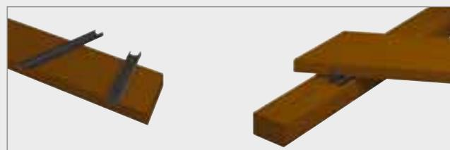
Макс. угол наклона несущей структуры относительно досок: 45°
