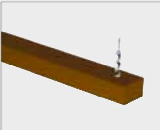
1. Разметьте осевую линию лаги, отметьте отверстия, затем просверлите отверстия диаметром 10 мм. Глубина отверстия зависит от монтажной высоты  $R$  и должна быть не менее 16 мм (размер втулки). Рекомендуемое максимальное расстояние между опорами составляет 60 см – необходимо уточнить в зависимости от рабочей нагрузки.
