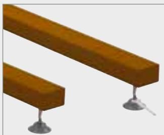
3. Переверните лагу и уложите её на основание, параллельно предыдущей. Отрегулируйте высоту опоры снизу, с помощью гаечного ключа на 10 мм.
