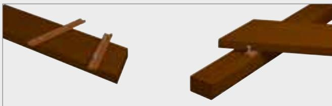
Макс. угол наклона несущей структуры относительно досок: 45°
