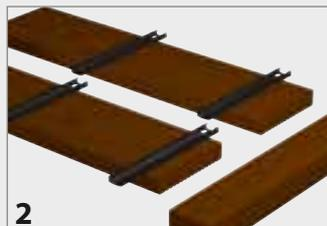
2. Установите один соединительный элемент Terralock 180 справа от прочерченной линии на расстоянии 5 мм. Для следующей доски повторите те же операции, но установите соединительный элемент слева от прочерченной линии, также на расстоянии 5 мм. Повторяйте эти шаги для всех досок.
