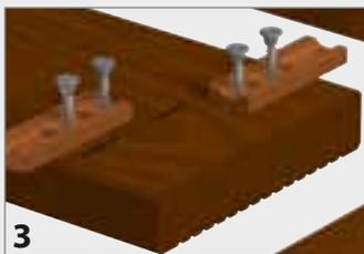
3. Закрепите каждый из двух соединительных элементов 2 шурупами ККФ, проверив с помощью монтажного ограничителя, что они вошли в доску.
