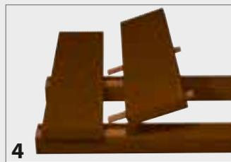
4. Поверните доску и задвиньте её под ту, которая была закреплена на несущей конструкции перед ней. 5. Закрепите каждый соединительный элемент на несущей конструкции с помощью шурупа ККФ, который вставляется в развальцованное отверстие. Для того чтобы получить зазор нужной ширины, рекомендуется использовать дистанционные проставки DIS, которые вставляются между досками.
