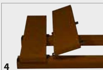
4. Поверните доску и задвиньте её под ту, которая была закреплена на несущей конструкции до неё.
