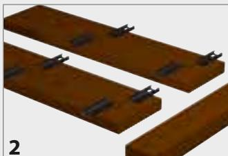
2. Для каждой доски и рядом с каждый крепёжным узлом расположите по одному соединительному элементу Terralock 60 справа и слева от прочерченной линии на расстоянии 5 мм, таким образом, чтобы два круглых отверстия оказались внутри доски для обоих соединительных элементов.
