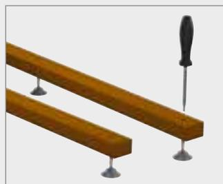
3. Переверните лагу и уложите её на основание, параллельно предыдущей. Отрегулируйте высоту опоры сверху, с помощью отвёртки с прямым шлицем.
