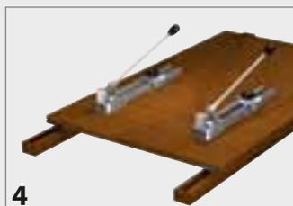
4. Сняните обе доски с помощью инструмента Crab. Теперь зазор между досками равен 7 мм.
